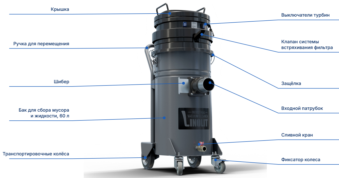
Рис. 1. Промышленный пылесос LINOLIT® 652 W — общий вид и органы управления
